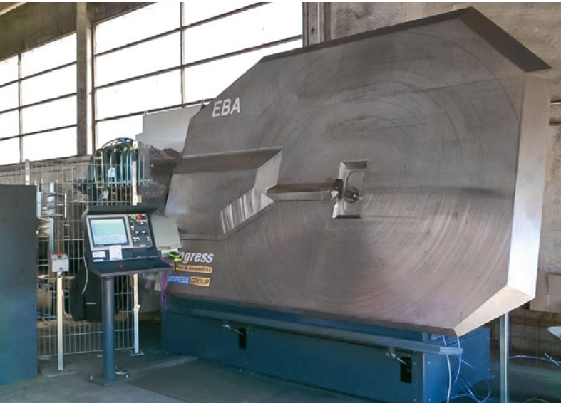
Eine der drei neuen EBA Biegebügelautomaten, die in 2021 angeschafft wurden.
