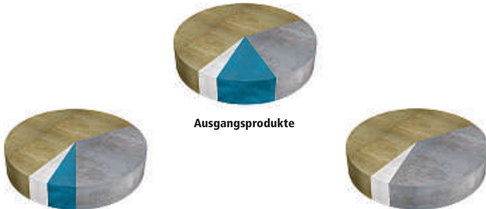
Reaktionsprodukte: Zement als Portlandzement (max. chemisch eingebunden W/Z-Wert=0,25)
